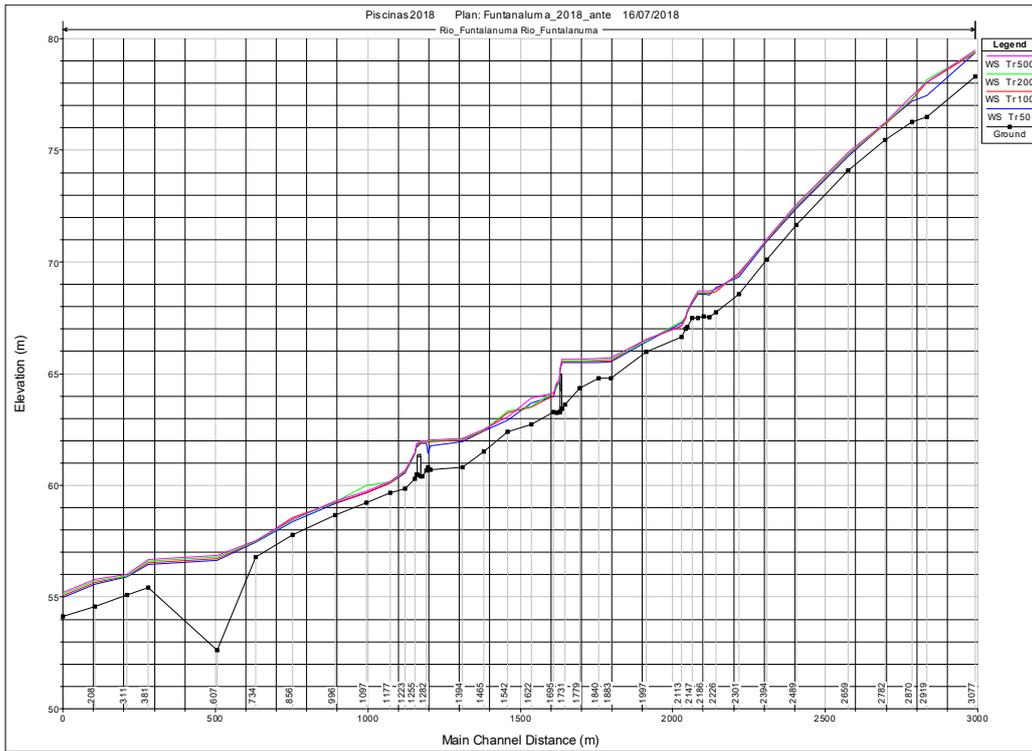
**Figura 8 – Profilo idraulico**
